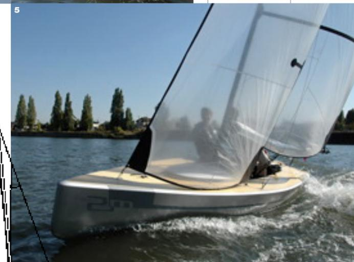
epoxy. Il fiocco misura 7,3 mq e la randa ben 16,7mq per una superficie velica totale di 24 metri quadri. Design, Fritsch-associés, produzione Naval Force3, La Rochelle, foto di Michel La Clavière YCIF.
